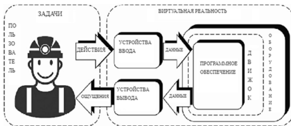
Рисунок 2. Общая схема взаимодействия с VR оборудованием
