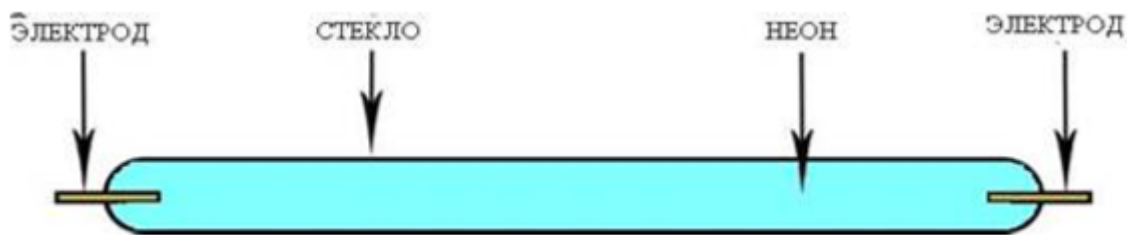
Рисунок 4. Конструкция неоновой лампы
