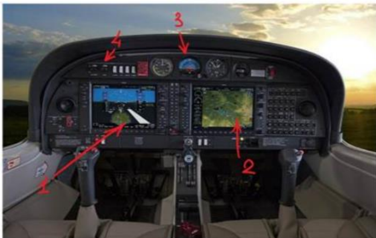
Рисунок 1. Самолёт DA-40 NG расположение резервных приборов
