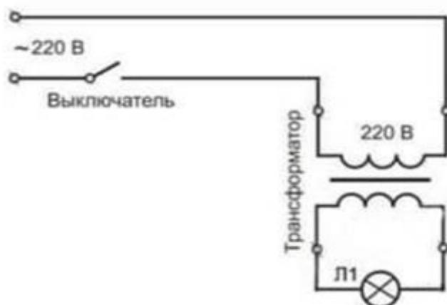
Рисунок 3. Электрическая схема подключения галогенной лампы, работающей от постоянного тока
