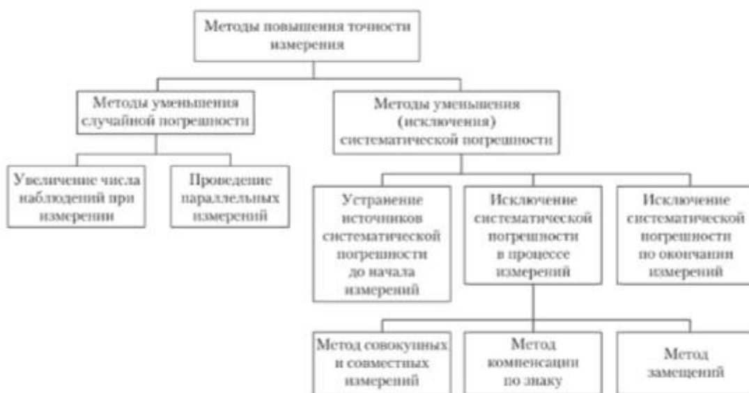
Рисунок 1. Структура методов повышения точности измерений
