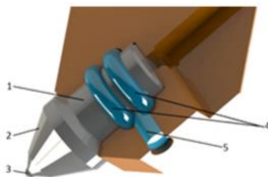
Рисунок 2. Конструкция поворотных резцов: 1 - Хвостовик резца, 2 - Головка резца, 3 - Твердосплавный наконечник, 4 - Полимерный материал, 5 - Отверстие для заливки
