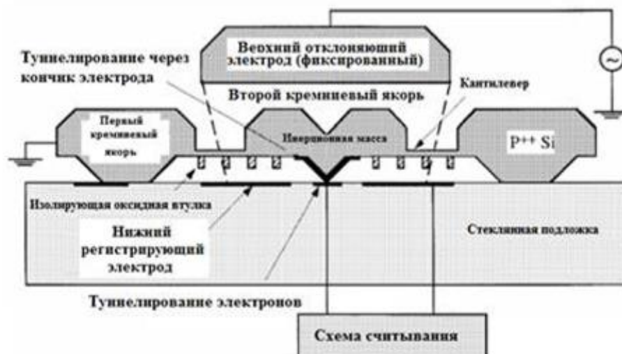
Рисунок 1. Пример конструкции туннельного акселерометра
