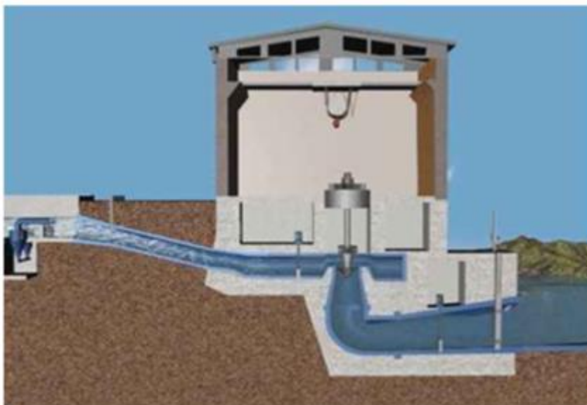
Рисунок 1. Общая технологическая схема усовершенствованного варианта малой ГЭС, снабженная гидроциклоном
